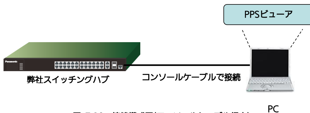
図 7-20 接続構成図(コンソールケーブル経由)
