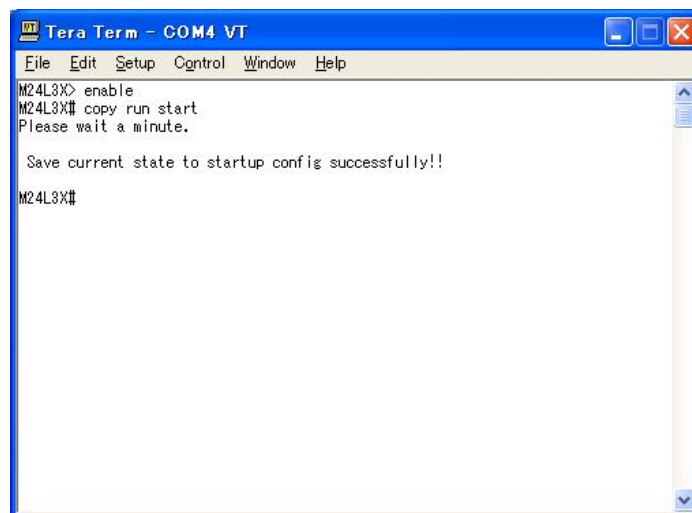
図 12 設定情報保存の実行 (copy running-config startup-config)
