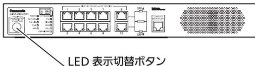
前面部にある LED 表示切替ボタンを使用して、接続している端末との接続確認の表示（ステータスモード）、給電（PoE）の表示（給電モード）、1000Mbps の伝送速度の表示（GIGA モード）、100Mbps または 10Mbps の伝送速度の表示（スピードモード）、全二重または半二重の伝送方式表示（DUPLEX モード）、ループ発生した履歴があるポートの表示（ループヒストリーモード）、全てのポート LED を消灯（ECO モード）させることができます。
