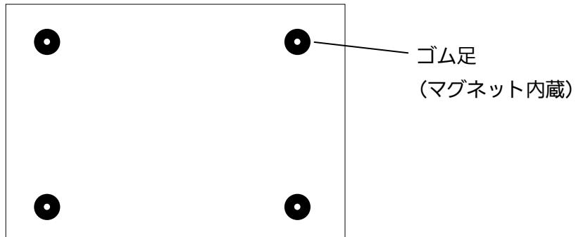
図2-1 スチール製製品への設置
