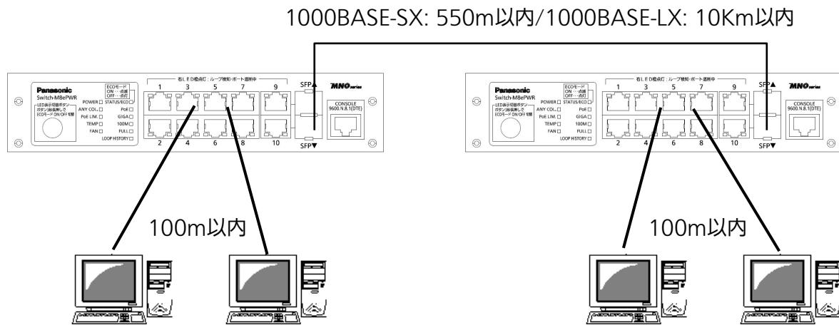
図0-2 光ファイバケーブル接続例
