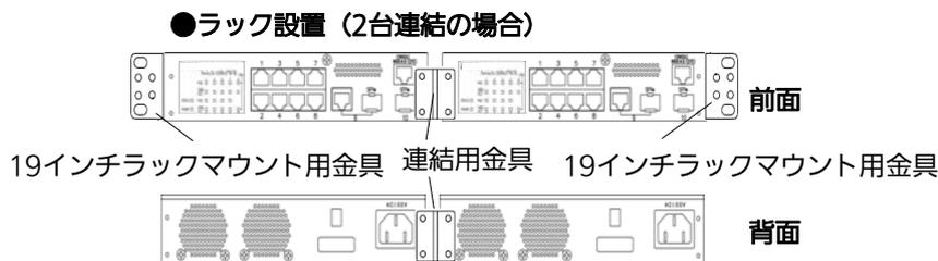
図2-4 19インチラックへの設置（2台連結の場合）
