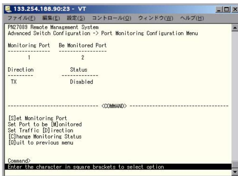
図4-7-14 ポートのモニタリング設定
