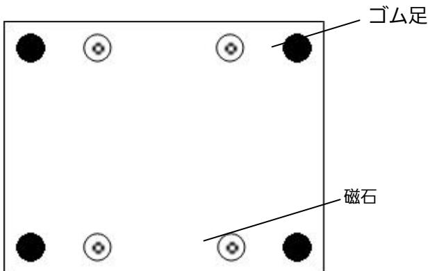
図2-1 スチール面への取り付け
