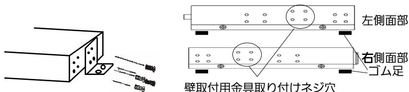
図2-5 壁への取り付け
