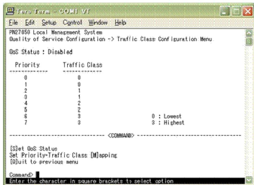
図4-7-8 トラフィッククラスの設定
