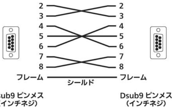
図A D-sub9ピン - D-sub9ピン コンソールケーブル結線仕様
