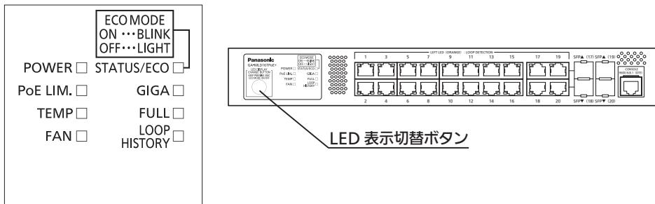
前面部にある LED 表示切替ボタンを使用して、接続している端末との接続確認の表示（ステータスマード）、1000Mbps の伝送速度の表示（GIGA モード）、全二重または半二重の伝送方式表示（DUPLEX モード）、ループ発生した履歴があるポートの表示（ループヒストリーモード）、全てのポート LED を消灯（ECO モード）させることができます。
