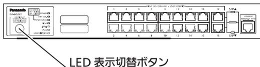
前面部にある LED 表示切替ボタンを使用して、接続している端末との接続確認の表示（ステータスモード）、1000Mbps の伝送速度の表示（GIGA モード）、100Mbps または 10Mbps の伝送速度の表示（スピードモード）、全二重または半二重の伝送方式表示（DUPLEX モード）、ループ発生した履歴があるポートの表示（ループヒストリーモード）、全てのポート LED を消灯（ECO モード）させることができます。
