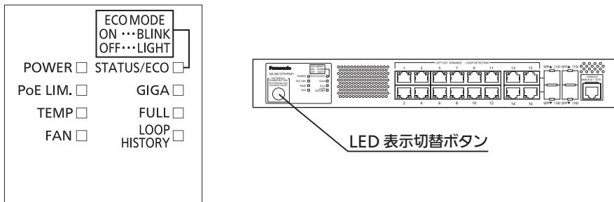
前面部にある LED 表示切替ボタンを使用して、接続している端末との接続確認の表示（ステータスマード）、1000Mbps の伝送速度の表示（GIGA モード）、全二重または半二重の伝送方式表示（DUPLEX モード）、ループ発生した履歴があるポートの表示（ループヒストリーモード）、全てのポート LED を消灯（ECO モード）させることができます。
