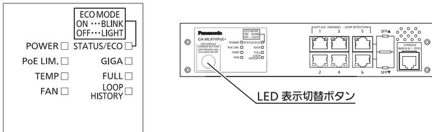
前面部にある LED 表示切替ボタンを使用して、接続している端末との接続確認の表示（ステータスモード）、1000Mbps の伝送速度の表示（GIGA モード）、全二重または半二重の伝送方式表示（DUPLEX モード）、ループ発生した履歴があるポートの表示（ループヒストリーモード）、全てのポート LED を消灯（ECO モード）させることができます。
