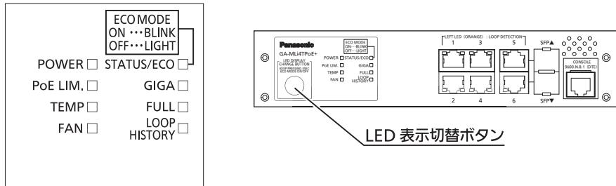
前面部にある LED 表示切替ボタンを使用して、接続している端末との接続確認の表示（ステータスマード）、1000Mbps の伝送速度の表示（GIGA モード）、全二重または半二重の伝送方式表示（DUPLEX モード）、ループ発生した履歴があるポートの表示（ループヒストリーモード）、全てのポート LED を消灯（ECO モード）させることができます。
