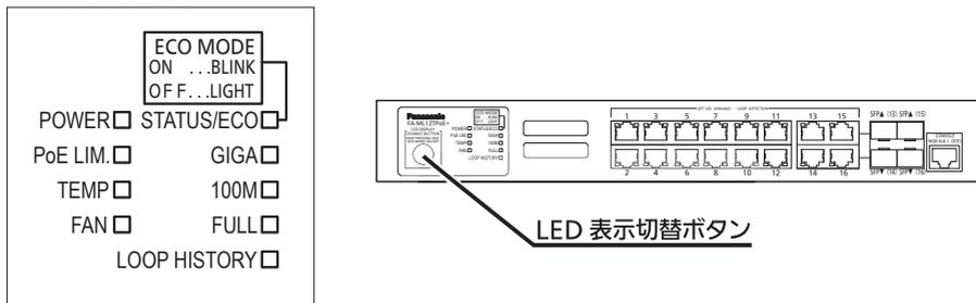
前面部にある LED 表示切替ボタンを使用して、接続している端末との接続確認の表示（ステータスモード）、1000Mbps の伝送速度の表示（GIGA モード）、100Mbps または 10Mbps の伝送速度の表示（スピードモード）、全二重または半二重の伝送方式表示（DUPLEX モード）、ループ発生した履歴があるポートの表示（ループヒストリーモード）、全てのポート LED を消灯（ECO モード）させることができます。
