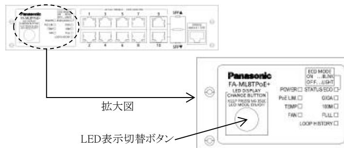
2種類のベースモードと各モードのLEDは以下のように切替えができます。
