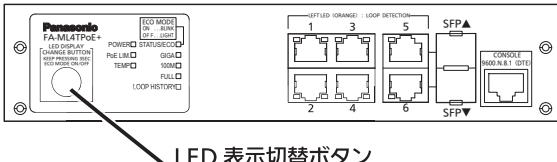
前面部にある LED 表示切替ボタンを使用して、接続している端末との接続確認の表示（ステータスマード）、1000Mbps の伝送速度の表示（GIGA モード）、100Mbps または 10Mbps の伝送速度の表示（スピードモード）、全二重または半二重の伝送方式表示（DUPLEX モード）、ループ発生した履歴があるポートの表示（ループヒストリーモード）、全てのポート LED を消灯（ECO モード）させることができます。
