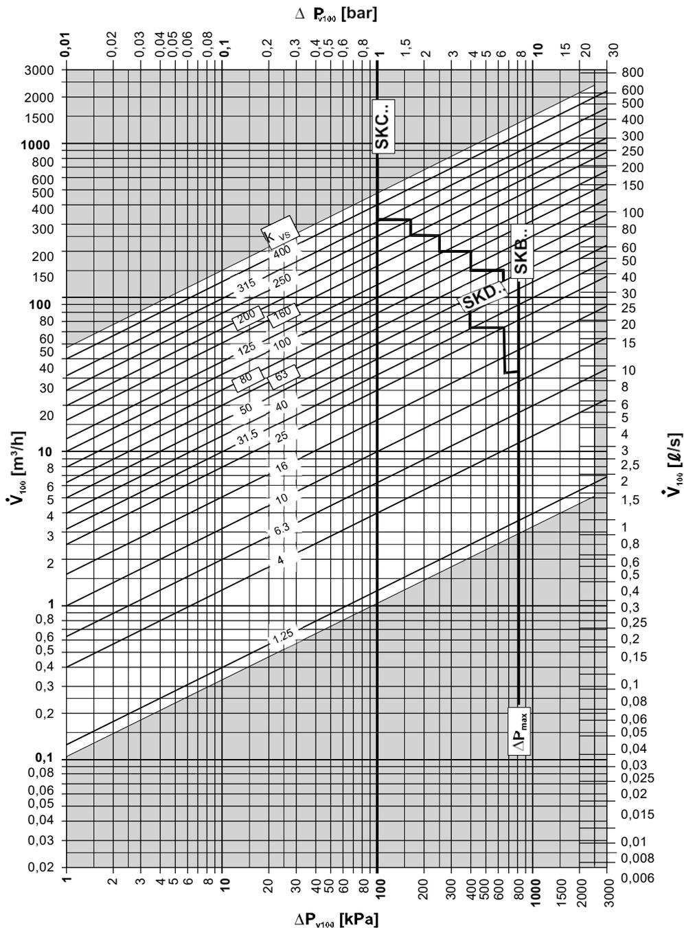
$\Delta P_{max}$ の値は混合三方弁の場合に適用、分流弁の場合の $\Delta P_{max}$ は〈形番一覧〉の項参照
