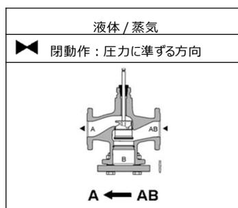
(注) 電油式アクチュエータをA→ABで液体に使用し低ノイズの運転可能。
