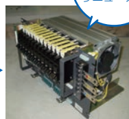
調光盤内器修繕ユニット ユニット単位で取替可能。
